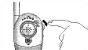
**3** Druk op de AAN/UIT-knoppen van de oudereenheden (B-9, C-10) om deze in te schakelen en stel het volume in op het gewenste niveau met behulp van de Volumeregelaars (B-9, C-10).
